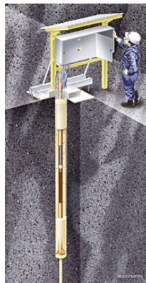
Lotförsöket består av paket med kopparrör omgivna av block av bentonitlera. Illustration: Jan Rojmar
