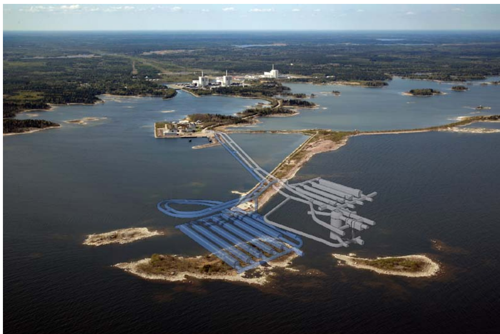
Figur 4-2. Befintlig SFR-anläggning (ljusgrå) och nuvarande planer för full utbyggnad (blå). Observera att den slutliga utformningen av utbyggnaden av SFR ännu inte är fastställd. Största delen av utbyggnaden planeras utgöras av bergsalar anpassade för lågaktivt avfall (BLA).
